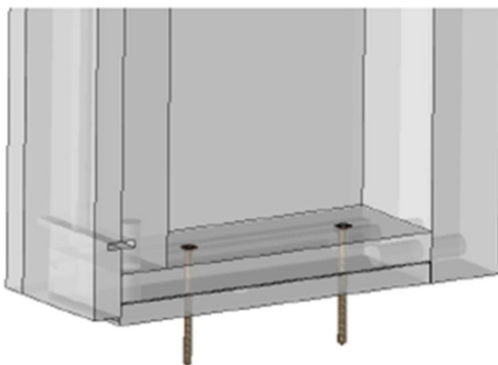
Skisse viser punkt 5, tilslutning mot gulv/tak
