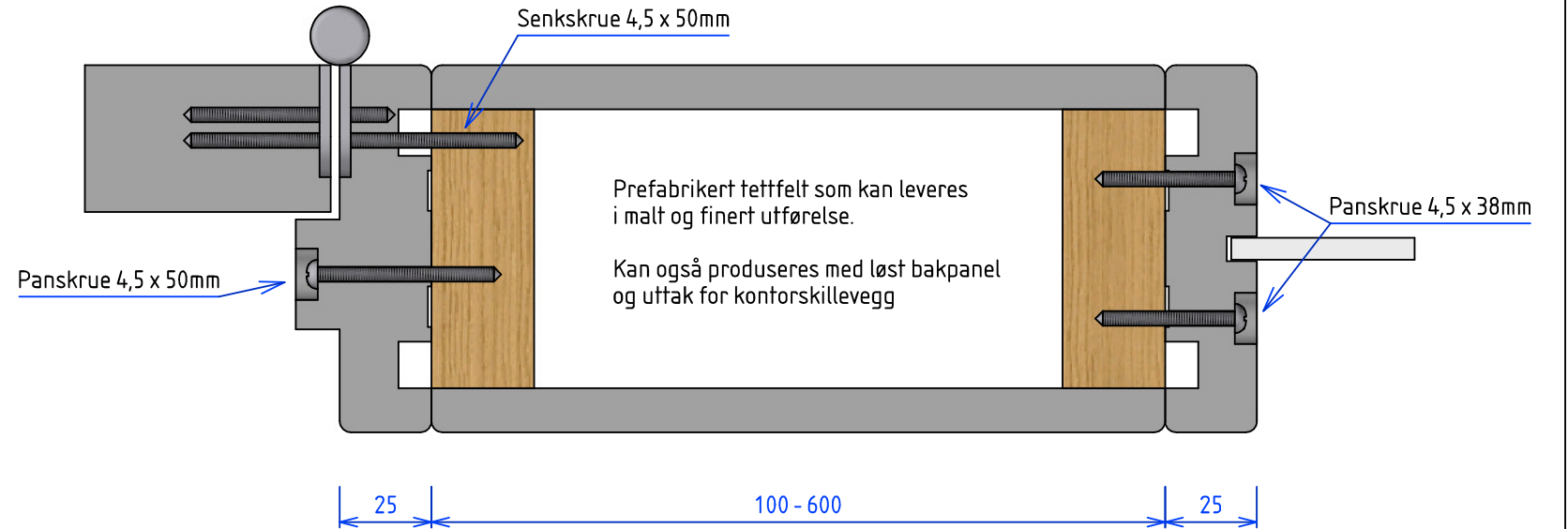
Alternativ 3, med prefabrikkert tettfelt
